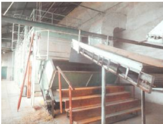
Pásová sušárna s klimatizáci chmele TS5-051 z Nového Mesta nad Váhom
