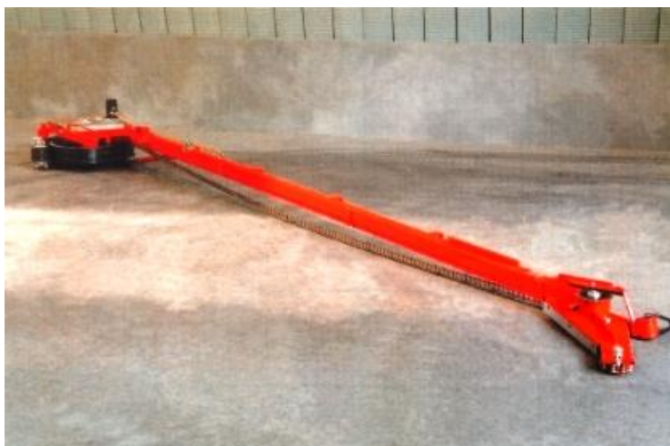
Strhávač chmelových rév jako adaptér na traktor
